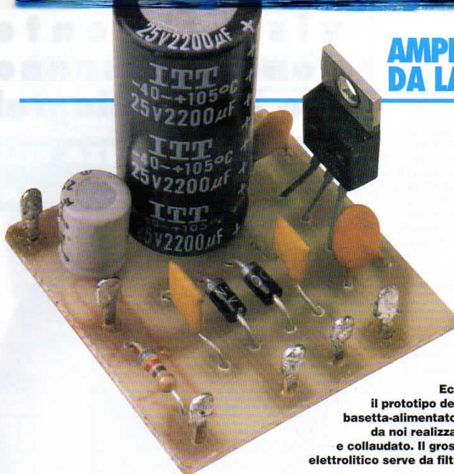
**Ecco il prototipo della basetta-alimentatore da noi realizzato e collaudato. Il grosso elettrolitico serve da filtro.**
