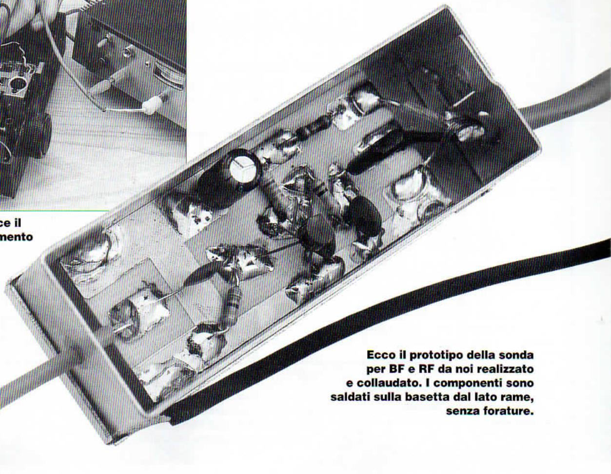
**Ecco il prototipo della sonda per BF e RF da noi realizzato e collaudato. I componenti sono saldati sulla basetta dal lato rame, senza forature.**
